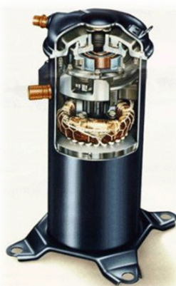
Compressore scroll ermetico
