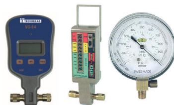
Varianti di vacuometri: quello analogico non viene più consigliato
