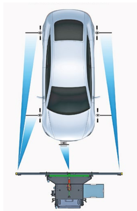
En une seule étape, le radar, mais aussi la caméra frontale, peuvent être réajustés une fois que la cible est géométriquement correcte. Photo: Bosch
