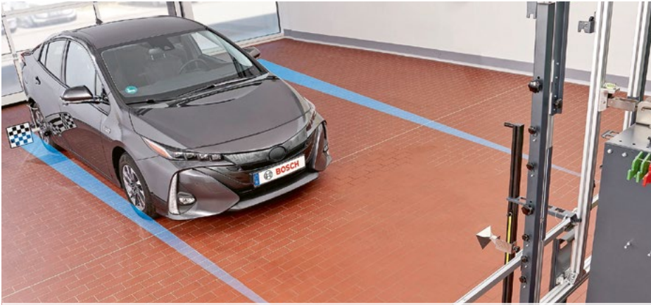
L'étalonnage statique des capteurs radar s'effectue soit, comme pour de nombreux modèles de véhicules de constructeurs automobiles japonais ou sud-coréens, au moyen d'un réflecteur radar ou de simples cibles. La base est toujours l'alignement précis des outils de mesure sur l'axe géométrique de déplacement, afin de procéder à l'ajustement conformément au fabricant.
