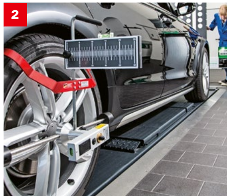
1 Même pour les véhicules utilitaires, le calibrage statique des capteurs SAC est coûteux. Mais l'étendue du travail est en principe identique à celle des voitures de tourisme. 2 L'alignement des cibles sur l'axe de conduite géométrique peut également être réalisé au moyen d'adaptateurs de géométrie de direction bon marché. 3 L'étalonnage des systèmes de caméras d'environnement nécessite la mise en place de tapis cibles autour du véhicule, qui doivent être mesurés avec précision. 4 Pour l'étalonnage de la caméra frontale, des cibles peintes sont appropriées, car elles aident la caméra à ajuster son Aspect aux circonstances à l'aide d'un logiciel. L'inconvénient: il existe des cibles spécifiques pour presque chaque marque. Il est plus élégant et fait gagner du temps d'afficher les cibles soit avec un grand téléviseur/écran, soit, comme sur l'image, avec un écran de vidéoprojecteur pour afficher les différentes cibles. Photos: Bosch (2), Hella Gutmann, Würth.
