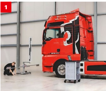
1 Même pour les véhicules utilitaires, le calibrage statique des capteurs SAC est coûteux. Mais l'étendue du travail est en principe identique à celle des voitures de tourisme. 2 L'alignement des cibles sur l'axe de conduite géométrique peut également être réalisé au moyen d'adaptateurs de géométrie de direction bon marché. 3 L'étalonnage des systèmes de caméras d'environnement nécessite la mise en place de tapis cibles autour du véhicule, qui doivent être mesurés avec précision. 4 Pour l'étalonnage de la caméra frontale, des cibles peintes sont appropriées, car elles aident la caméra à ajuster son Aspect aux circonstances à l'aide d'un logiciel. L'inconvénient: il existe des cibles spécifiques pour presque chaque marque. Il est plus élégant et fait gagner du temps d'afficher les cibles soit avec un grand téléviseur/écran, soit, comme sur l'image, avec un écran de vidéoprojecteur pour afficher les différentes cibles. Photos: Bosch (2), Hella Gutmann, Würth.
