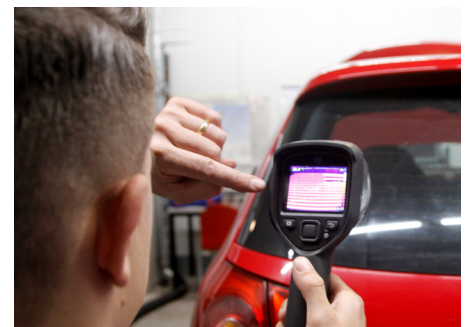
Funktioniert die Heckscheibenheizung vollflächig? Mittels Thermografie lässt sich die Heizleistung oder der Strom durch die Heizdrähte visualisieren.
