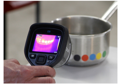
Glatte Metalloberflächen haben einen kleinen Emissionsgrad und reflektieren mehr Wärmeenergie, als dass sie diese ausstrahlen. Textilkontakte mit rauer Oberfläche sorgen für reine Abstrahlungsenergie.
