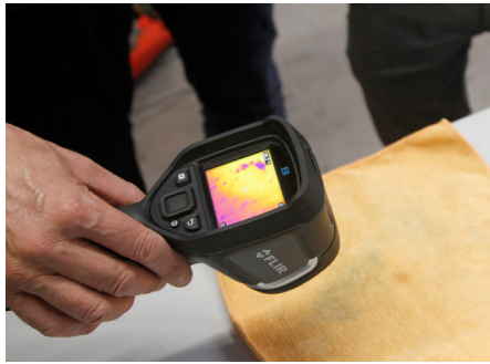
Unter dem gelben Lappen hat Weingartner vor der Messung ein paar Tropfen Wasser «versteckt». Das aufgesogene Wasser lässt die Temperaturabstrahlung ändern. Die Wärmebildkamera macht diese sichtbar.
