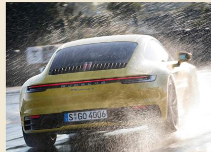
Der aktuelle Porsche 911 erkennt dank zwei Mikrofonen je in den vorderen Radkästen, dass der Reibwert durch Nässe geringer wird und konditioniert die Fahrwerksregelsysteme präventiv.
