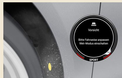
Es gibt keinen Sensor, der den Reibwert  $\mu$  zwischen Reifen und Fahrbahn messen kann. Entsprechend wird das Geräusch der Gischt im Radkasten mittels Piezomikrofonen gemessen, um eine Information über die Höhe des Wasserstandes auf der Fahrbahn zu erhalten.
