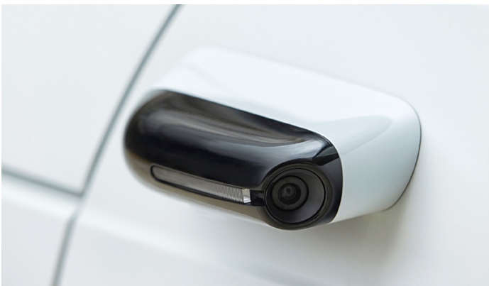
D'abord sur des VU chez Mercedes-Benz, puis sur l'Audi e-tron et maintenant sur l'innovante Honda e : de petites caméras et de petits écrans dans l'habitacle remplacent les rétroviseurs pour réduire la résistance de l'air. Photo Honda
