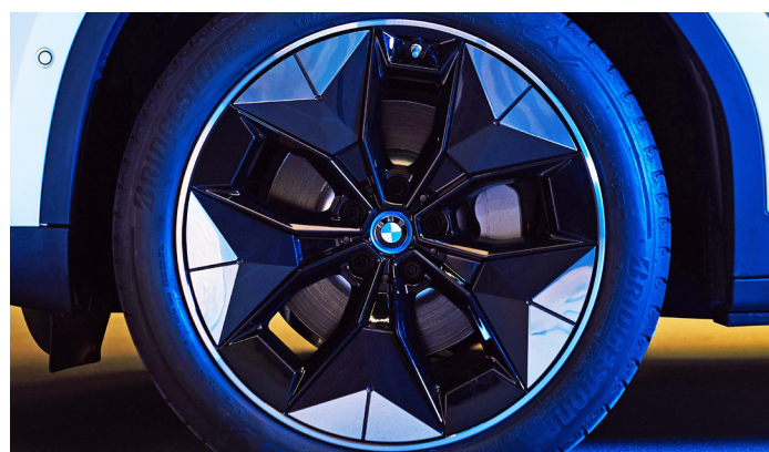
Nouvelle propulsion, nouvelles idées : pour réduire la consommation d'énergie, l'iX3 est équipée de jantes en alliage léger aérodynamiques. Photo BMW
