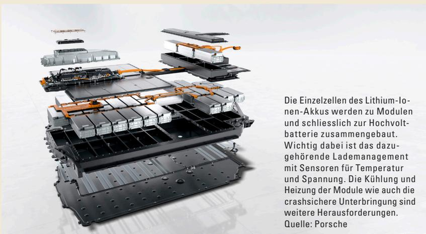
Die Einzelzellen des Lithium-Ionen-Akkus werden zu Modulen und schliesslich zur Hochvolt-Batterie zusammengebaut. Wichtig dabei ist das dazugehörige Lademanagement mit Sensoren für Temperatur und Spannung. Die Kühlung und Heizung der Module wie auch die crashsichere Unterbringung sind weitere Herausforderungen. Quelle: Porsche
