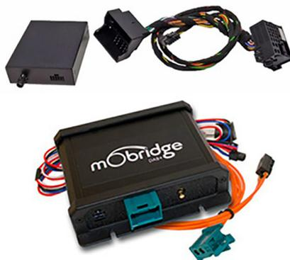
Zusatzsteuergeräte auf dem freien Markt sind preiswerter als USB-, CAN-Bus- (Bild oben) oder MOST-Bus-Variante (Bild unten) und lassen sich dank programmierbaren Schnittstellen ins Fahrzeug integrieren, damit beispielsweise die Lenkradfernbedienung funktioniert. Fotos: Exklusiv Car-Hifi
