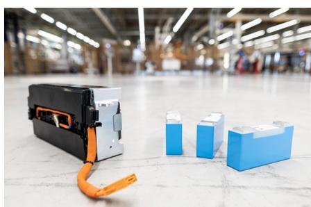
Die einzelnen Zellen werden in einem Zellmodul zusammengefasst. Damit die Produktion ungefährlich ist, weist ein Zellmodul in der Regel weniger als 60 Volt Gesamtspannung aus. Foto: Mercedes-Benz
