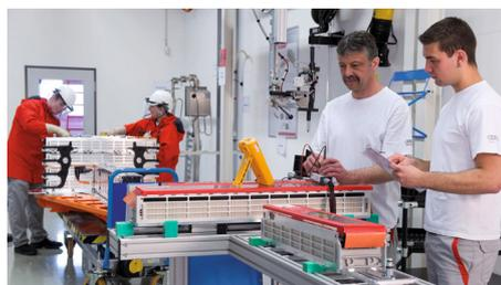
So wird es bei den Garagisten in Zukunft in der Werkstatt aussehen: Wer an Hochvoltbatterien arbeitet, muss höchste Arbeitssicherheitsvorschriften einhalten (hinten). Reparaturen an Modulen oder Zellen werden irgendwann zum Alltag der Werkstattmitarbeiter gehören. Aus- und Weiterbildung ist in diesem Bereich zentral. Foto: Audi
