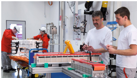
Voici ce à quoi les ateliers des garages ressembleront à l'avenir: quiconque travaille sur des batteries haute tension devra respecter de strictes consignes de sécurité au travail (au fond). Les réparations de modules et de cellules feront partie du quotidien des collaborateurs des ateliers. La formation initiale et continue occupe le devant de la scène dans ce domaine. Photo: Audi
