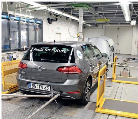
Erste Prüfstandsmessungen zeigen deutlich: Verbrenner mit E-Fuels sind gleich sauber wie mit fossilem Treibstoff. Um die Emissionslimiten einzuhalten, muss weiterhin auf eine teure Abgasnachbehandlung gesetzt werden. Foto: ADAC
