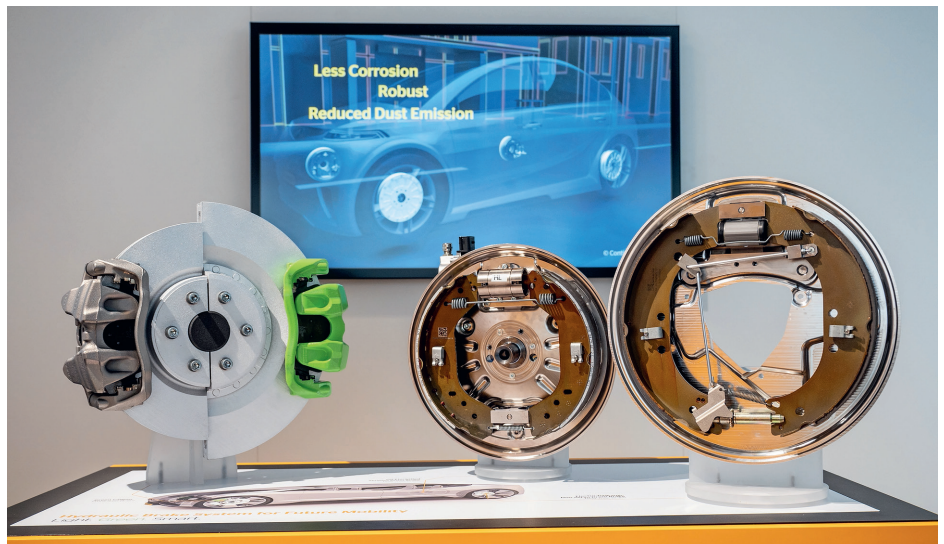
En raison de la limitation des émissions maximales de poussières de freinage, le frein à tambour connaît une renaissance. Grâce à une version fermée, les émissions de particules fines sont nettement moindres. Photo : Continental
