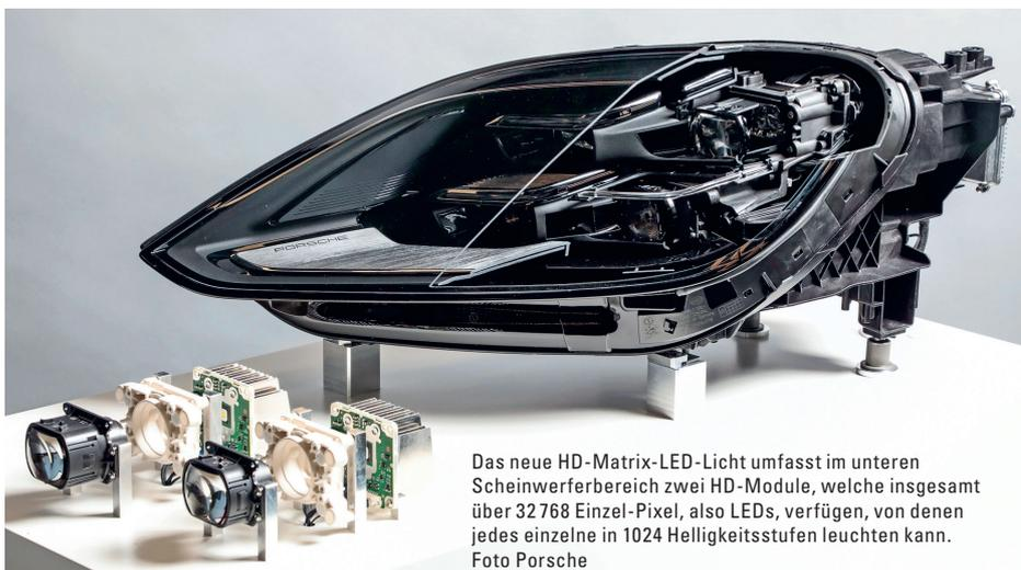
Das neue HD-Matrix-LED-Licht umfasst im unteren Scheinwerferbereich zwei HD-Module, welche insgesamt über 32.768 Einzel-Pixel, also LEDs, verfügen, von denen jedes einzelne in 1024 Helligkeitsstufen leuchten kann. Foto Porsche
