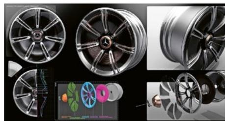
Vollverschaltete Räder mit Zentralmuttern wurden aus dem Rennsport in das Konzeptfahrzeug Mercedes-Benz EQXX transferiert. Die Aerodynamik und damit der Luftwiderstand sinken dadurch spürbar. Foto: Mercedes
