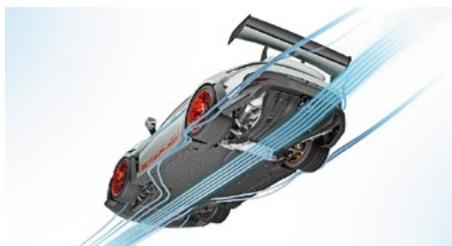
Down-force-Kräfte lassen sich zwar mit martialischen Heckflügeln erreichen. Ein Diffusor an der Hinterachse sorgt bei hohen Geschwindigkeiten für Anpresskraft und damit hohe Fahrzeugstabilität. Foto: Porsche
