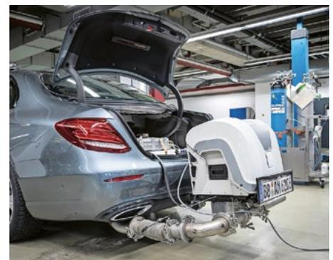
Bei Zulieferern und Automobilherstellern werden millionenteure Abgasmessanlagen verwendet, um auf dem Prüfstand (links) oder auf der Strasse (rechts) präzise und reproduzierbare Messungen vorzunehmen. Foto: Mercedes
