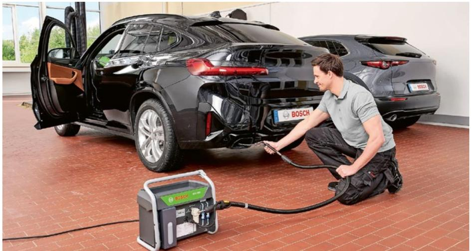
Die Endrohrmessung zur Zählung der Partikelanzahl/cm<sup>3</sup> Luft erfordert ein eigenes Prüfgerät, dessen Wartung essenziell ist, um Messfehler zu vermeiden und korrekte Aussagen über den Zustand des DPF zu tätigen. Foto: Bosch
