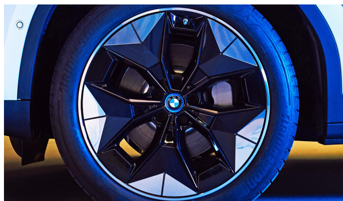
Neuer Antrieb, neue Ideen: Um den Energieverbrauch von BEV zu drücken, wird der iX3 luftwiderstandsoptimierte Leichtmetallräder erhalten. Bild BMW
