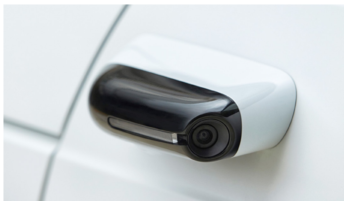
Zuerst im Nutzfahrzeug bei Mercedes-Benz, dann im Audi e-tron und jetzt im innovativen Honda e: Rückspiegel werden zur Senkung des Luftwiderstandes durch kleine Kameras und Displays im Innenraum ersetzt. Bild Honda
