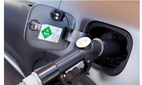
Die Betankung von FC-Fahrzeugen ist für Kunden einfach: Der gasförmige Wasserstoff strömt innert fünf Minuten in die 700-bar-Tanks. Bild Hyundai
