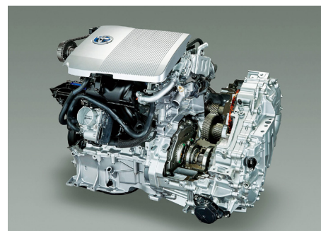
Vorreiter des leistungsverzweigten Hybrid: Im Toyota Prius sorgen ein Verbrenner und zwei E-Motoren/-Generatoren für stufenloses Fahren. Quelle: Toyota
