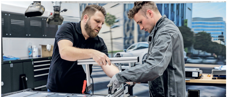
Les modules de batterie sont souvent montés dans la caisse de la batterie à l'aide d'une pâte thermique afin d'optimiser les transferts thermiques lorsque la voiture fonctionne. Un module défectueux doit donc être extrait mécaniquement à l'aide d'un cadre.
