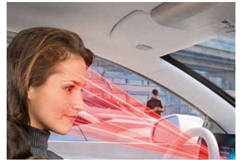
Die Überwachung des Fahrzeugführers durch Innenkameras ist eine Grundvoraussetzung dafür, damit Level-3-FAS zugelassen werden. Erst ab Level 4 übernimmt das Fahrzeug die komplette Fahraufgabe und die Passagiere können sich anderen Aufgaben widmen. Die Erarbeitung entsprechender Regelungen wird aber noch andauern. Foto: Continental
